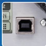
Firmware-Updates über rückseitige USB-Schnittstelle
